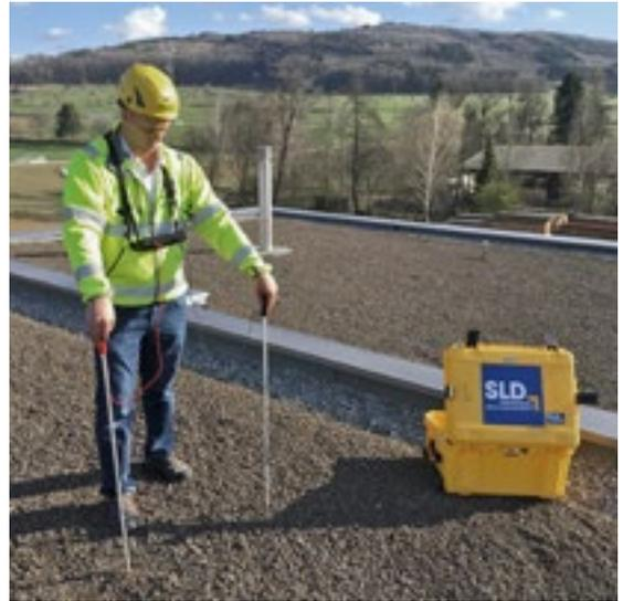
Dachhaut beschädigt und somit undicht werden. Zum anderen wird der bauphysikalische Aufbau der Flachdächer entscheidend beeinträchtigt. Vor der Montage einer PV-Anlage ist es empfehlenswert, das Dach einer Dichtigkeitsprüfung zu unterziehen. Sollten sich durch das Feuchtemonitoring mögliche Undichtheiten zeigen, können diese mit speziellen Messtechniken punktgenau geortet werden.
