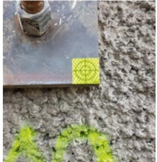
**V**erdichtetes Bauen ist heute immer mehr ein Thema. Die Bautätigkeit kann dadurch, aufgrund von Deformationen oder Erschütterungen, vermehrt Schäden an benachbarten Bauten verursachen. Dank Überwachungsmessungen (Geomonitoring) lassen sich Schäden verhindern, reduzieren oder zumindest gut dokumentieren, um frühzeitig für die notwendigen und aussagekräftigen Fakten zu sorgen – als Grundlage für eine spätere Beurteilung von Schäden.
